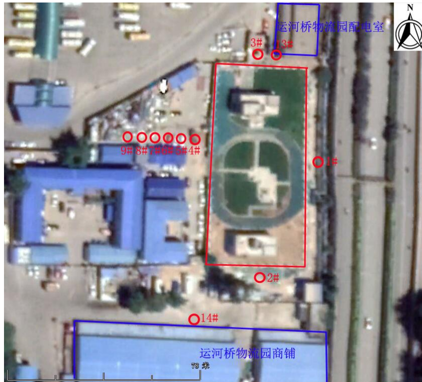
图 7-1 电磁环境监测布点图—建北主变电站
